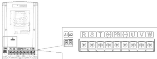
Рис. 4-11 15~18 кВт клеммы силовых цепей
